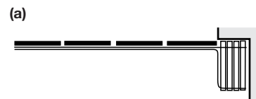
Example of door configuration with three doors ตัวอย่างการกำหนดรูปแบบจัดเก็บสำหรับบาน 3 บาน
