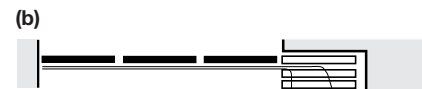
Example of door configuration with three doors - Pivoted door can be provided to close off door panel storage area ตัวอย่างการกำหนดรูปแบบจัดเก็บสำหรับบาน 3 บาน บานเปิดจุดหมุนสามารถติดตั้งเป็นบานสุดท้าย สำหรับปิดพื้นที่จัดเก็บบาน
