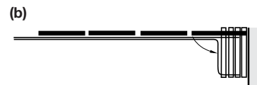
Example of door configuration with three doors - Pivoted door can be provided to close off door panel storage area ตัวอย่างการกำหนดรูปแบบจัดเก็บสำหรับบาน 3 บาน บานเปิดจุดหมุนสามารถติดตั้งเป็นบานสุดท้ายสำหรับปิดพื้นที่จัดเก็บบาน
