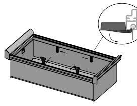
**STEP 1:** INSERT THE CLIPS INTO THE CHANNEL UNDER THE FRONT AND REAR CROSS BARS. THE CLIPS CAN BE PLACED ANYWHERE ALONG THE CHANNEL.
