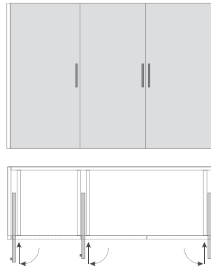
Doors closing against base and top section บานทับขอบ บน-ล่าง
