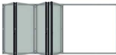
Folding of the connected elements พับบานได้อย่างง่ายดาย
